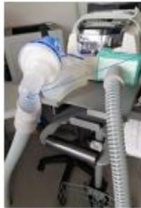
Fuga de 5 mm realizada con aguja de biopsia por punción (fuga calculada a 30-40 l/min a presión de 10 cm H2O)
